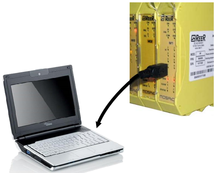
Şekil 2 - USB 2.0 ön panel konnektörü
